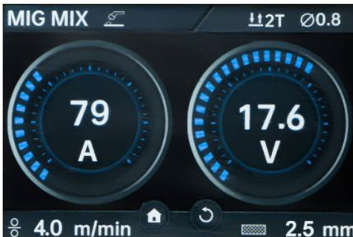
Kuva 13: Toimintonäyttö. Esimerkkiasetukset MIG MIX -menetelmälle myötöpäivään luoteltuna:
