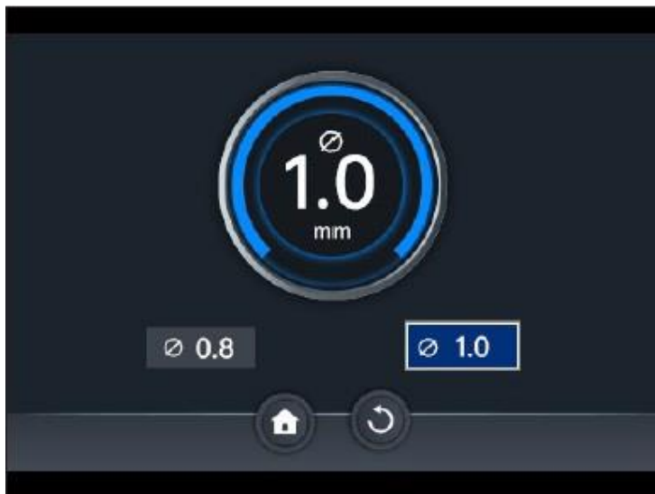
Kuva 10: Langan halkaisijan 0,8 mm tai 1,0 mm valinta (kiertämällä ja painamalla säädintä 5)
