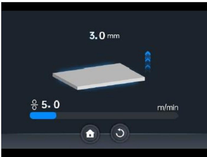
Kuva 12: Hitsausparametrien asetus (synergia) langansyöttönopeuden perusteella suhteessa hitsattavan materiaalin paksuuteen.
