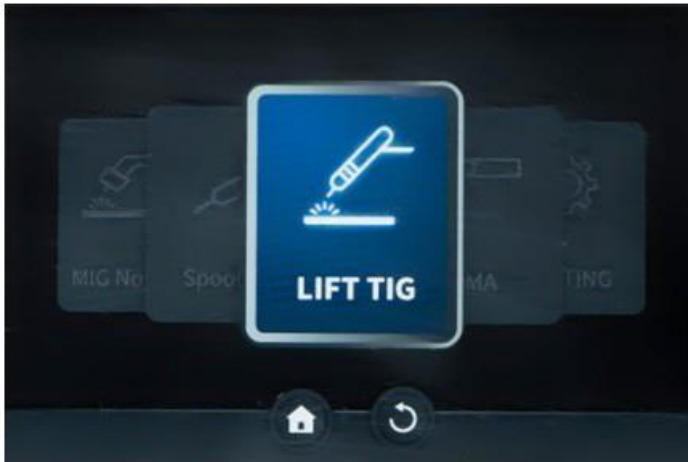
Kuva 19: LIFT TIG -menetelmän valinta
