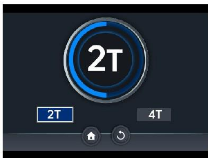
Kuva 11: Hitsauspolttimen liipaisimen toimintatavan valinta: 2-tahti tai 4-tahti
