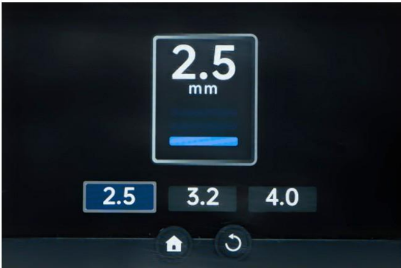
Kuva 26: MMA-päälystetyn elektrodin halkaisijan valinta
