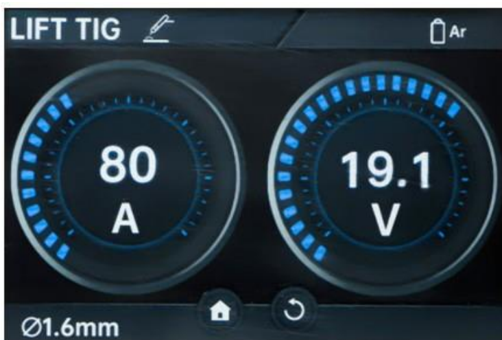
Kuva 22: Toimintonäyttö. Esimerkkiasetukset LIFT TIG -menetelmälle myötöpäivään lueteltuna: argonkaasu, valokaarijännite 19,1 V, hitsausvirta 80 A, volframielektrodin halkaisija 1,6 mm..
