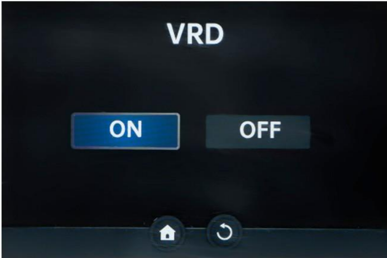
Kuva 25: VRD-toiminnon aktivointi (ON – päällä, OFF – pois päältä)
