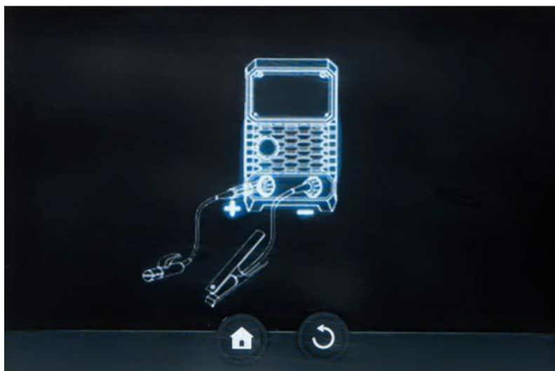
Kuva 24: Hitsauskaapeleiden liittäminen MMA-menetelmässä
