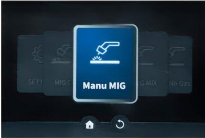
Kuva 14: MIG -menetelmän valinta, manuaaliset asetukset
