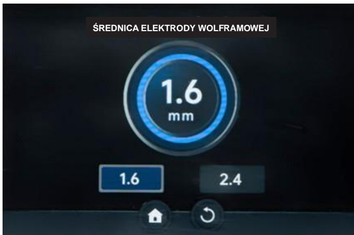
Kuva 21: Elektrodin halkaisijan valinta – tässä 1,6 mm (kiertämällä ja painamalla MENU-säädintä (5))
