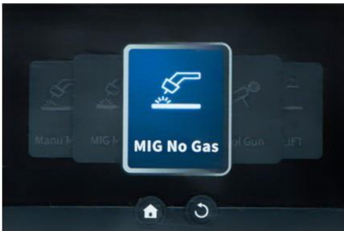
Kuva 17: MIG No Gas -menetelmän valinta
