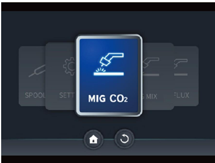
Kuva 3: Hitsausmenetelmän valinta (tässä MIG CO2)
