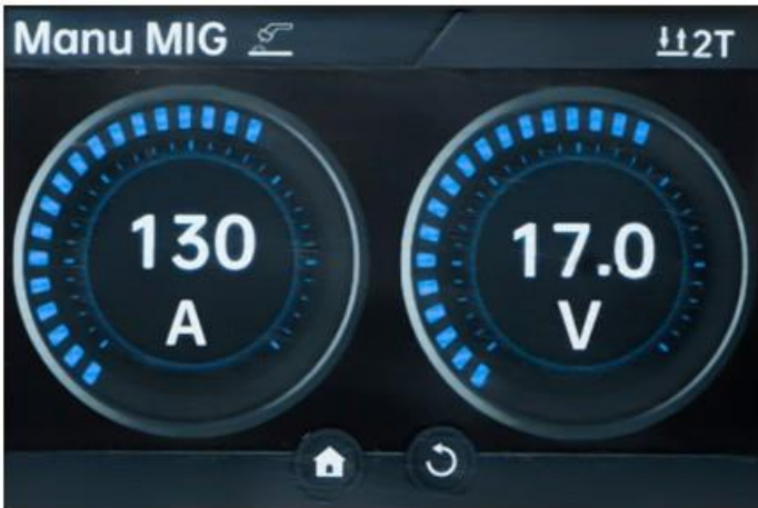
Kuva 16: Toimintonäyttö. Esimerkkiasetukset Manu MIG -menetelmälle myötäpäivään luoteltuna: 2T-tahti, hitsausvirta 130 A, valokaarijännite 17,0 V.
