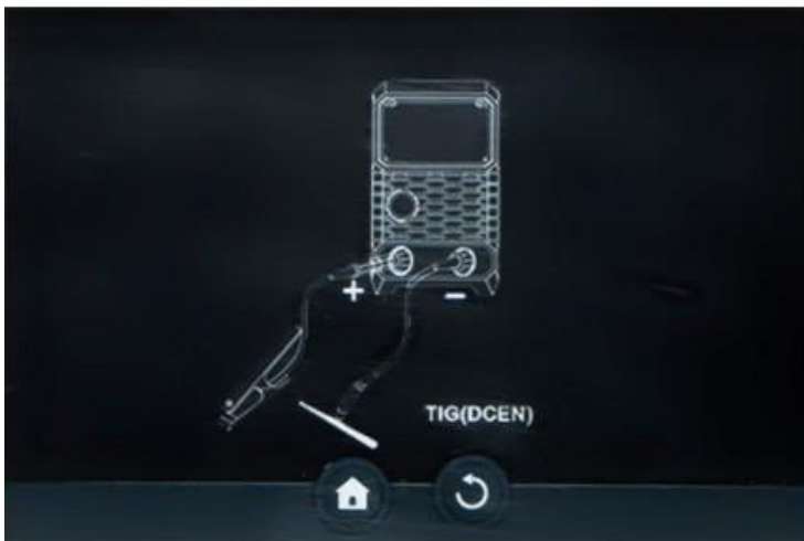
Kuva 20: Hitsauskaapeleiden liittäminen LIFT TIG -menetelmässä FANMIG J5 LCD MOST
